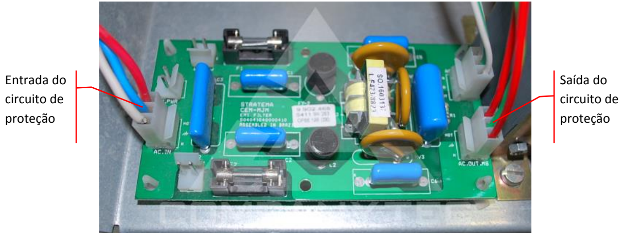
Figura 27 - Circuito de proteção
